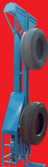
Schwerer LKW-Reifenlift (z.B. zur Beschickung von Shredderanlagen)
