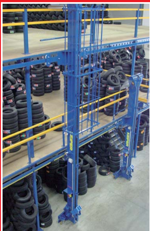
Mobiler Reifenlift zur Bestückung verschiedener Lagerebenen in einem Großlager
