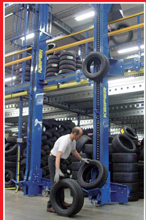
Reifenaufgabe an 2 Reifenliften für Förderhöhen von 4 bzw. 8 m
